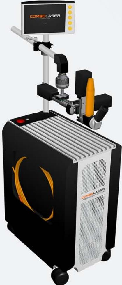
позволяющий изменять диаметр пятна в диапазоне 400...800 мкм. Легко умещаясь в руке LASERPEN дает возможность оперировать в труднодоступных зонах, в том числе зонах с ограниченной видимостью. Передача изображения системы видеонаблюдения ведется по радиоканалу с выводом на автономный дисплей. При необходимости манипулятор легко крепится к системе трехмерного позиционирования, позволяющей осуществлять работу в автоматическом режиме.
